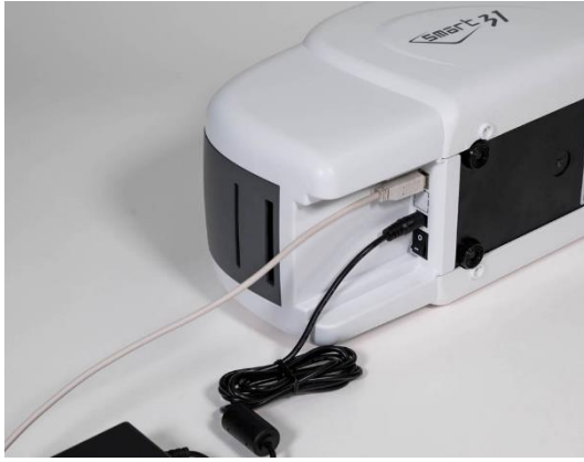
그림 9 SMART-31D 전원 및 통신포트 연결
