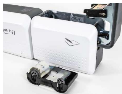
図22 ラミネートフィルム装着2
