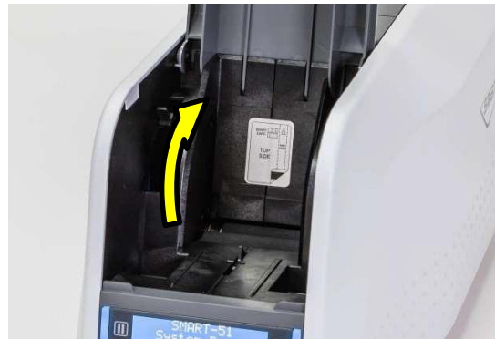
図24 カードの厚さ調整レバーを 調節する
