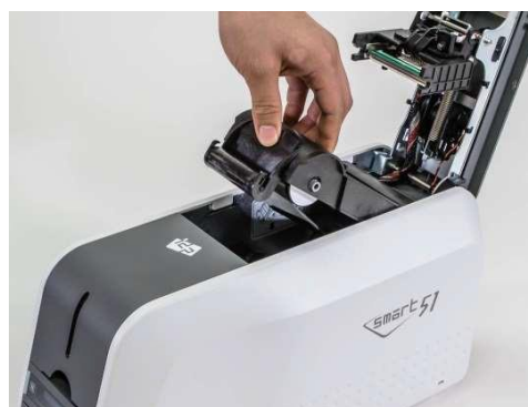
図19 リボンカートリッジを取り付けます
