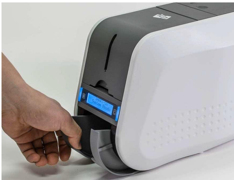
図32 SMART51スタッカーの取り外し
