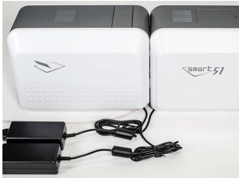
図12-SMART51L電源および通信ポート接続-2
